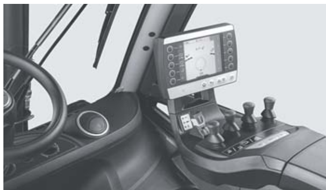
Veilige en intuïtieve bediening met de STILL Easy Control display en bediening
