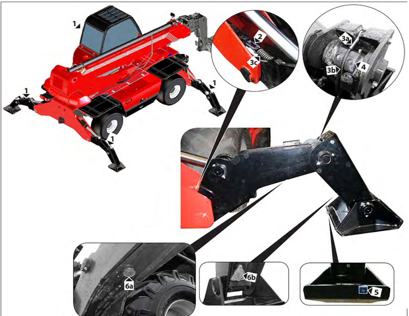
Figure 260: Vérification du système levage et d'abaissement des stabilisateurs
