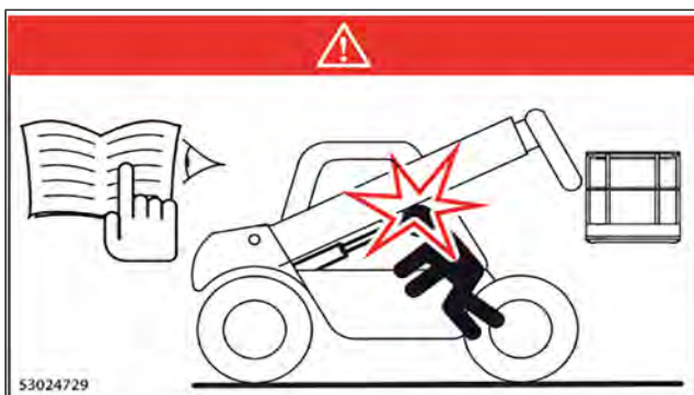
Figure 49: Autocollant - Danger Cale de sécurité de la flèche
