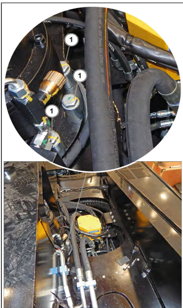
Figure 255: Vérification du serrage de la vis de fixation du réducteur de rotation
