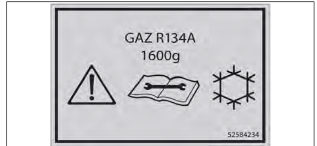
Figure 54: Recharge du système de climatisation
