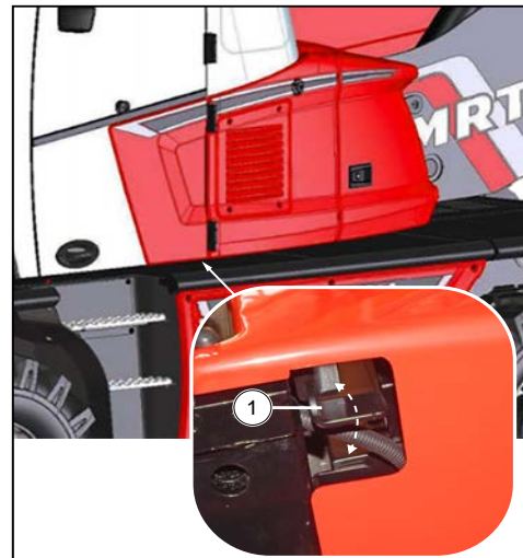
Afbeelding 61: Ontgrendelhendel voor deurruit buiten de cabine
