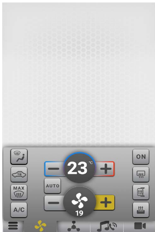
Afbeelding 80: Knop voor verwarming en klimaatregeling (optioneel)
