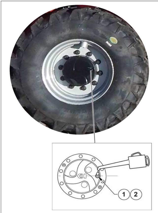
Afbeelding 162: Oliepeil van voor- en achterwielreductoren controleren
