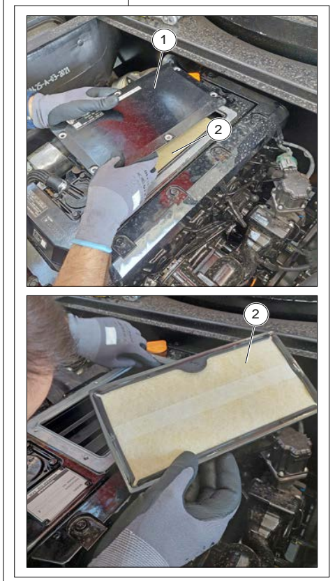
Afbeelding 209: Het carterfilter van de motorontluchter vervangen
