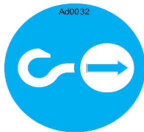
Afbeelding 58: aanduiding bevestigingspunten veiligheidsharnas.
