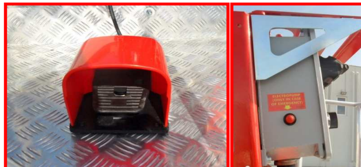
Afbeelding 10: “dodemanspedaal” en linkerkant van het kastje in de korf.
