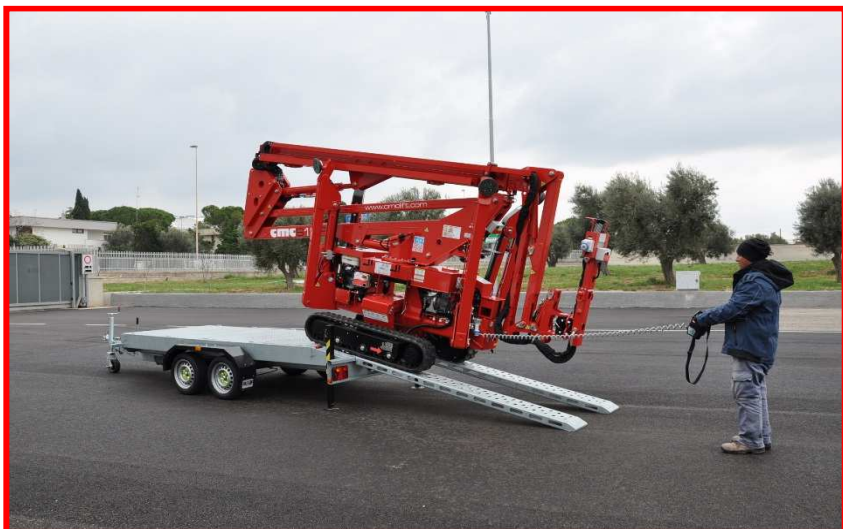
Afbeelding 13: laden/lossen door middel van oprit/afrit.
